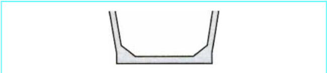
Figure 25 – Géométrie du bas de caisson d’un pont poussé à âmes inclinées
